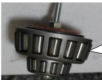
内部に入っている2連装の円錐コロ軸受け（この写真のボルトの上下は実験装置とは逆）
