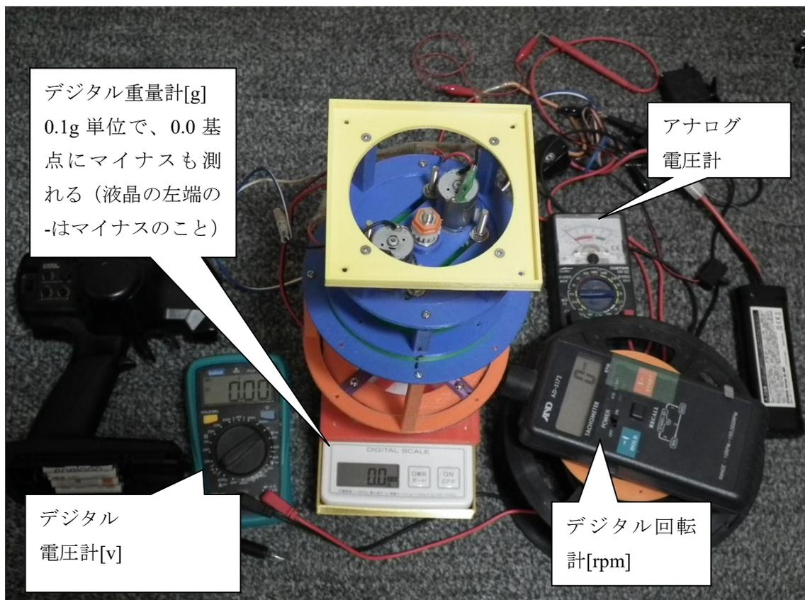
■ 2連装の円錐コロ軸受けの板バネによる安定した推進力の計測実験結果
