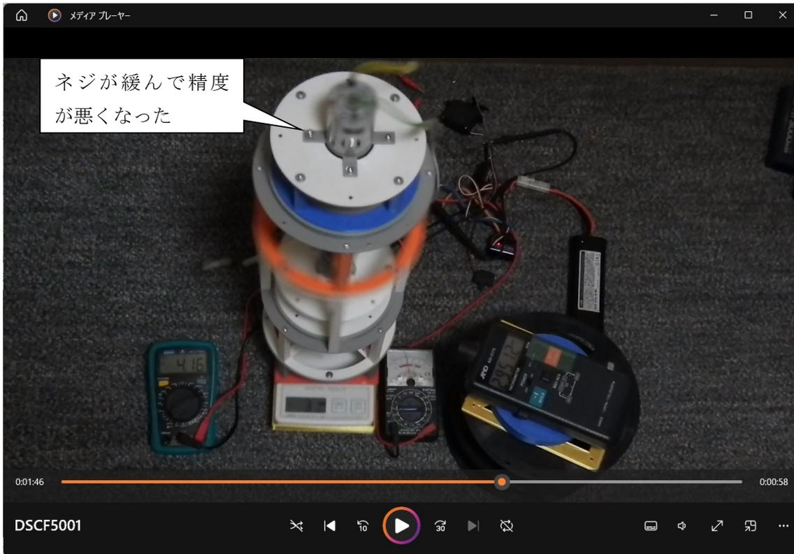
過去の実験で1ローターで回転させていた場合は自転的な歳差運動のような動きになったが、上下逆方向の2ローターでは歳差運動のようなことは起こらず、比較的安定して上方推進力が発生した。その推進力の発生回転数はかなり低く、上方推進力は大きい。
